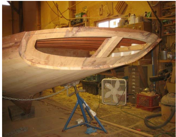
Fig. 22) MURMUR - laminated transom frame
