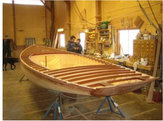
Fig. 32) MURMUR deck frame
