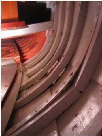
Fig. 13) Broken frames and sisters
